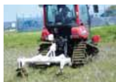
サブソイラーによる心土破砕
